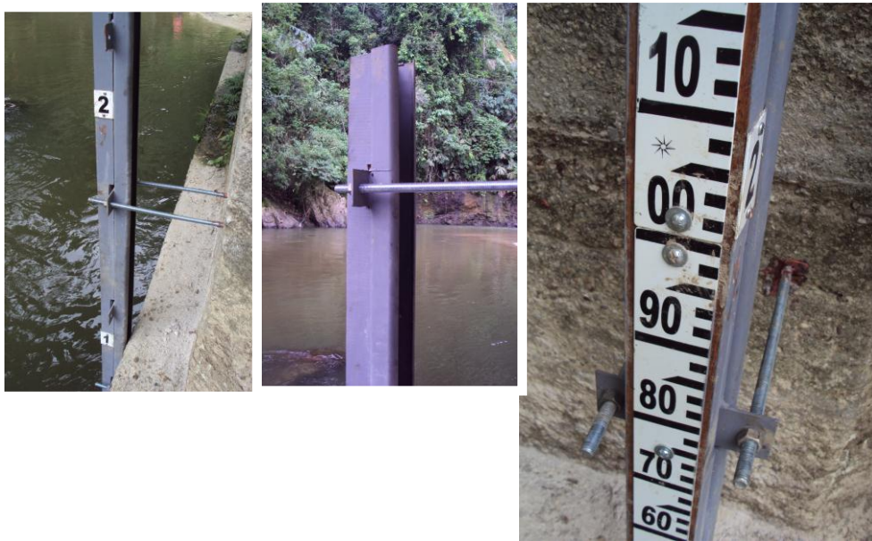
GRAFICO 35. Sistema de anclaje de los limnómetros de las estaciones para la medición de grandes caudales
