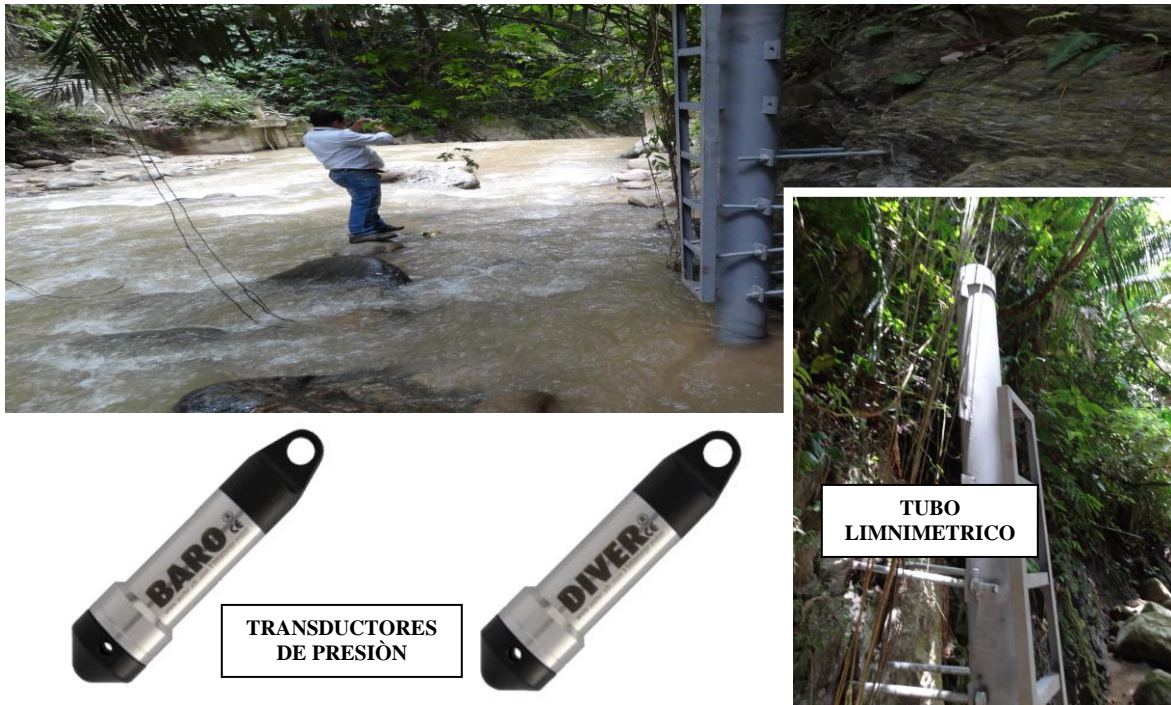
GRAFICO 15. Ubicación en terreno de la nueva estación automática de niveles “El Rasgón”.
